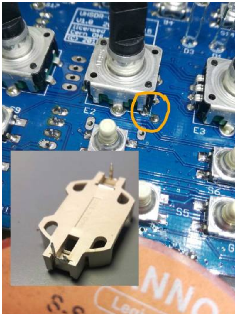
Möglicher Kurzschluß (photo DF9EH)
