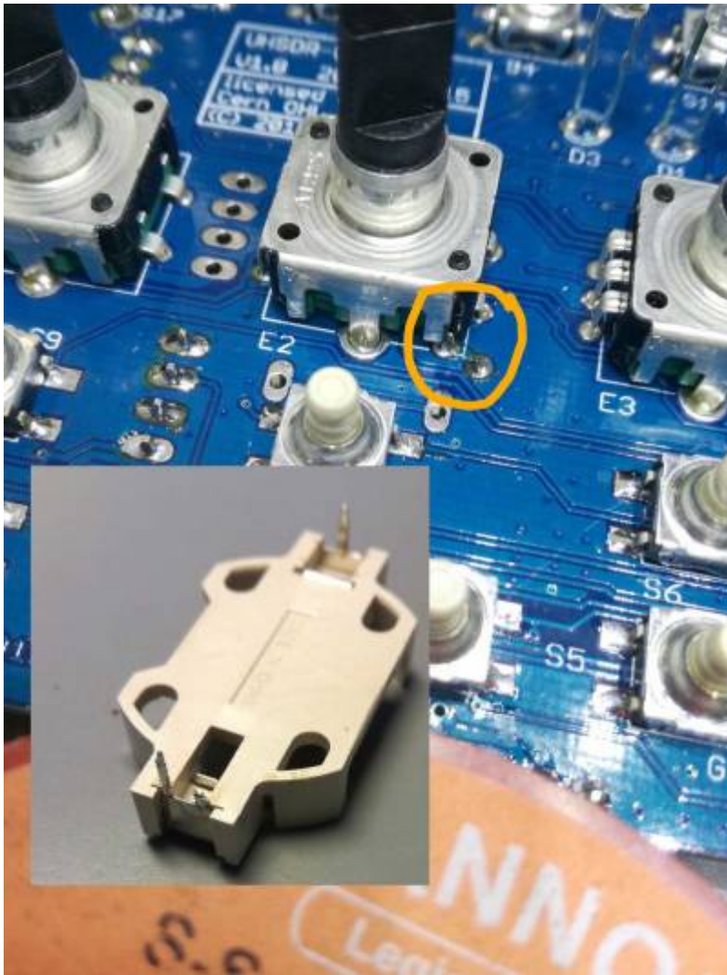
Möglicher Kurzschluß (photo DF9EH)
