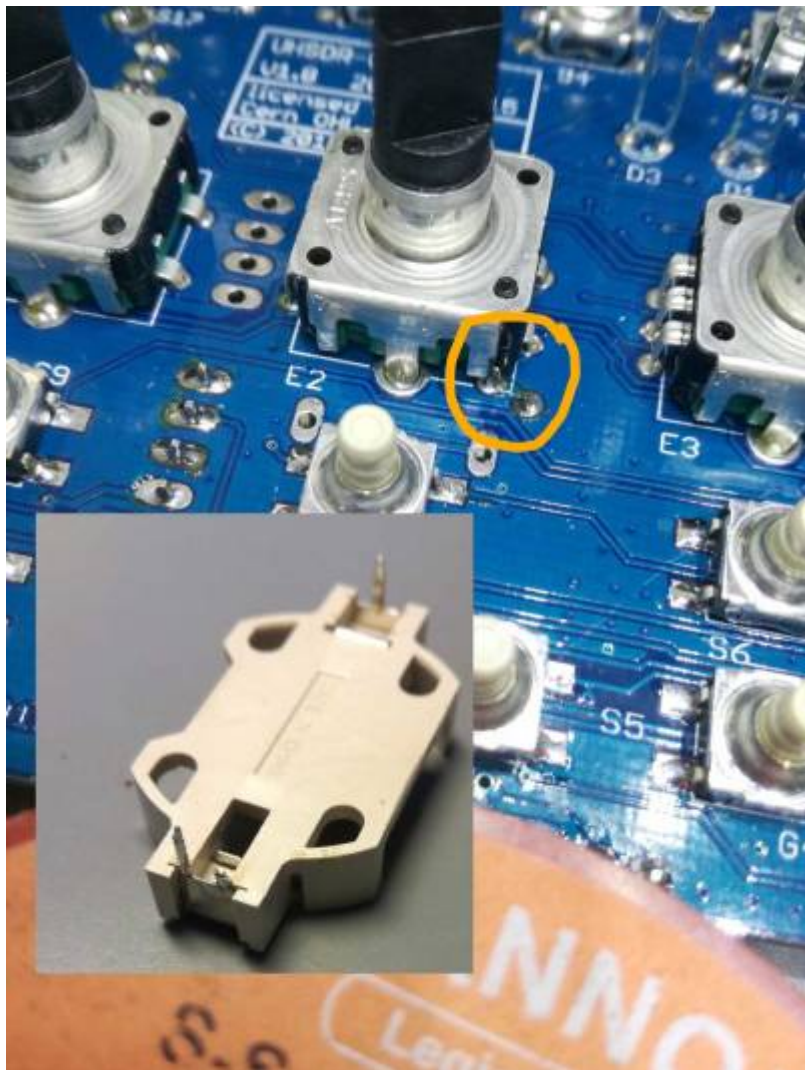
Möglicher Kurzschluß (photo DF9EH)
