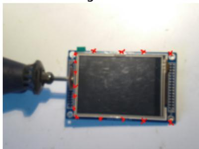
la nappe (câble plat) sort, doivent être maintenues. Sur le côté gauche (où les rangées de trous ont été sciées), il y a maintenant le risque que les pistes de PCB avec le support en aluminium du panneau se court-circuitent. Pour éviter cela, nous faisons levier sur le circuit imprimé à l'aide d'un scalpel, d'un cutter ou similaire. Soulevez de 0,5 mm et faites glisser une bande de scotch (Tesafilm) entre le PCB et le panneau. Le ruban se replie ensuite autour du circuit imprimé.
