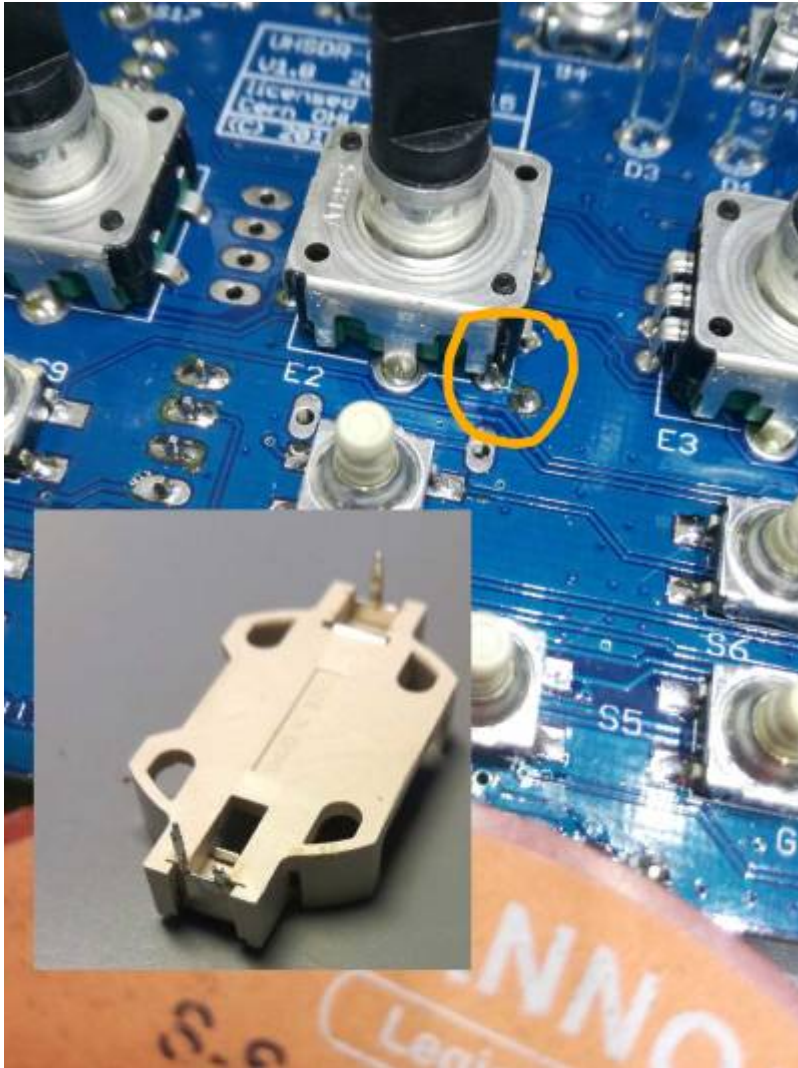
Möglicher Kurzschluß (photo DF9EH)
