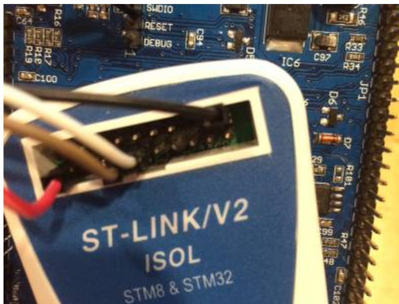
Connexion ST-Link vers la carte OVI40 UI (photo F4HTX)
