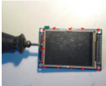
la nappe (câble plat) sort, doivent être maintenues. Sur le côté gauche (où les rangées de trous ont été sciées), il y a maintenant le risque que les pistes de PCB avec le support en aluminium du panneau se court-circuitent. Pour éviter cela, nous faisons levier sur le circuit imprimé à l'aide d'un scalpel, d'un cutter ou similaire. Soulevez de 0,5 mm et faites glisser une bande de scotch (Tesafilm) entre le PCB et le panneau. Le ruban se replie ensuite autour du circuit imprimé.
