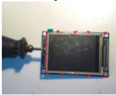
la nappe (câble plat) sort, doivent être maintenues. Sur le côté gauche (où les rangées de trous ont été sciées), il y a maintenant le risque que les pistes de PCB avec le support en aluminium du panneau se court-circuitent. Pour éviter cela, nous faisons levier sur le circuit imprimé à l'aide d'un scalpel, d'un cutter ou similaire. Soulevez de 0,5 mm et faites glisser une bande de scotch (Tesaflim) entre le PCB et le panneau. Le ruban se replie ensuite autour du circuit imprimé.
