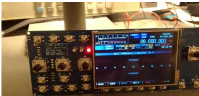
OVI40 UI et module LCD (photo DF9EH)
