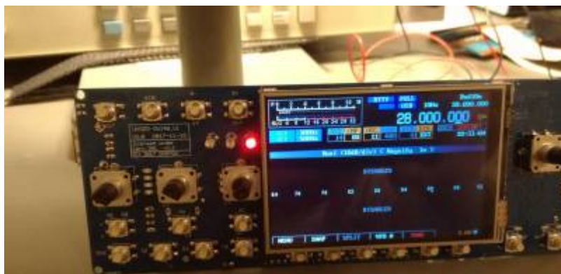
OVI40 UI et module LCD (photo DF9EH)
