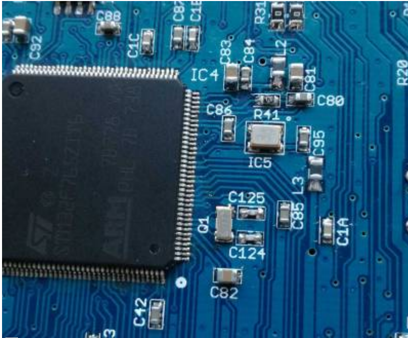
Orientation correcte TXCO & MCU (photo DF9EH)
