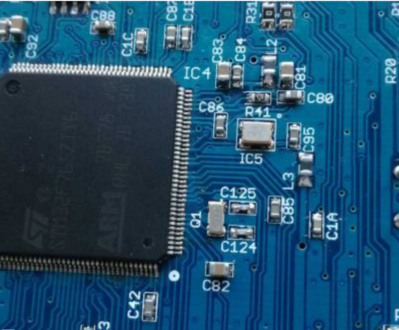
Orientation correcte TXCO & MCU (photo DF9EH)
