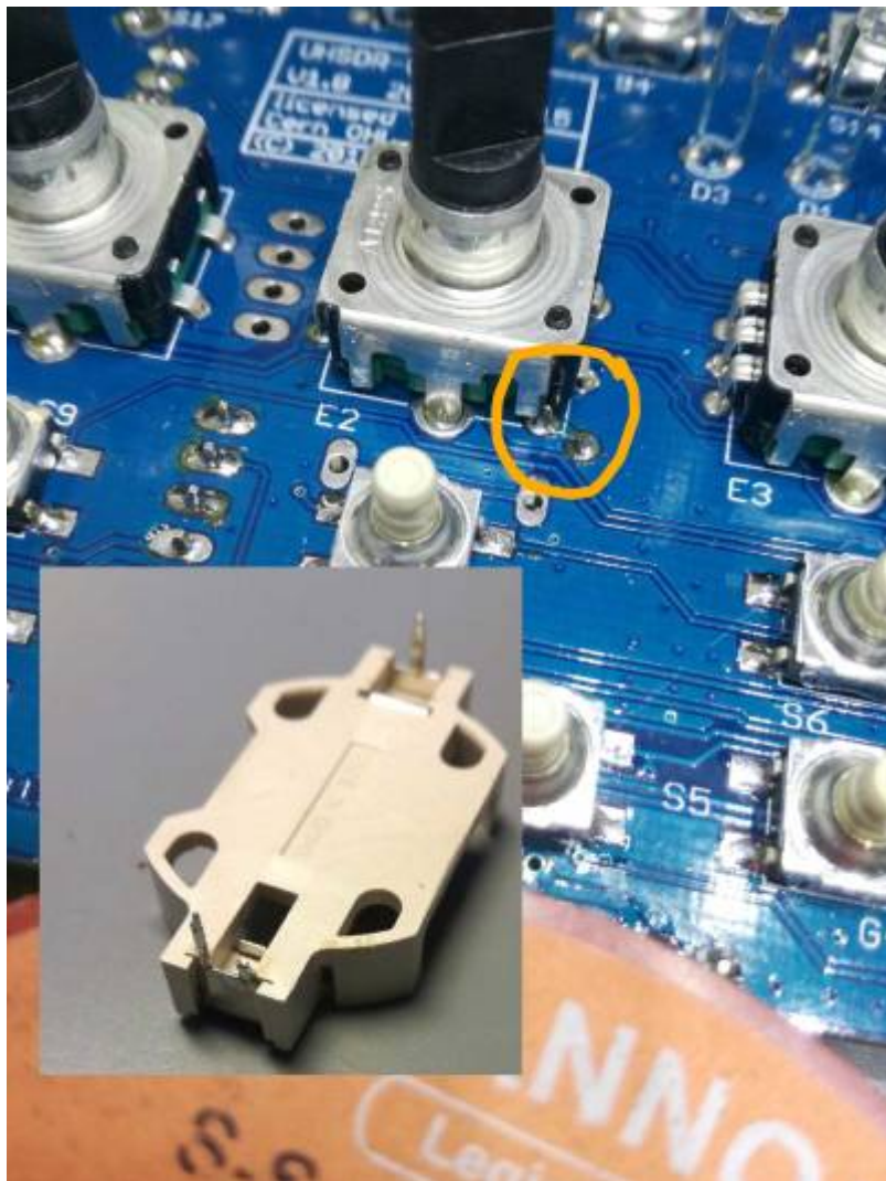
Court-circuit possible, à éviter (photo DF9EH)
