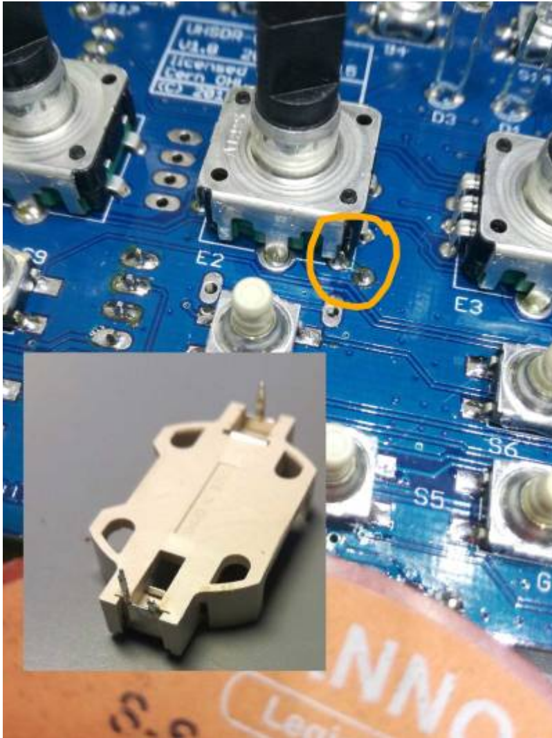
Möglicher Kurzschluß (photo DF9EH)
