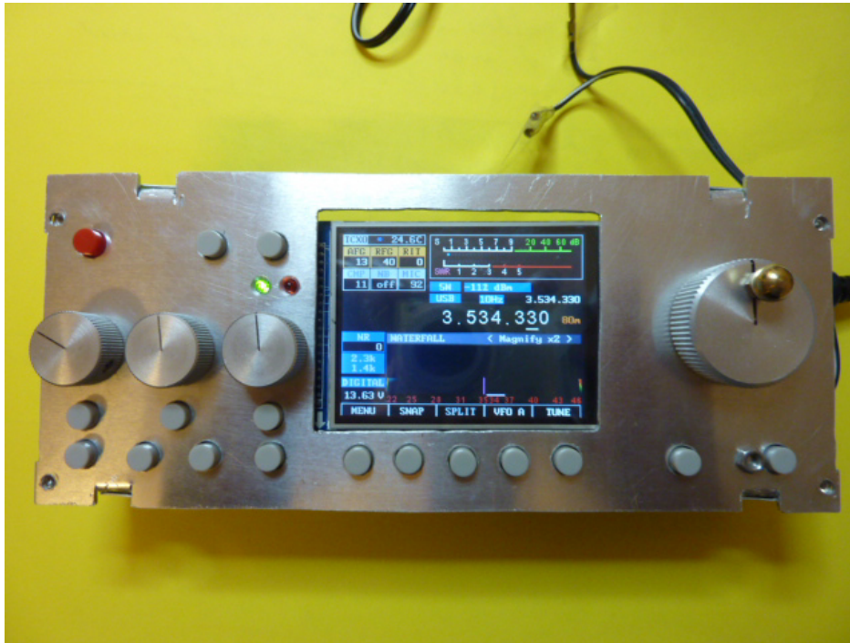
Neuer Ausschnitt altes Display, die Knöpfe stehen 3 mm über
