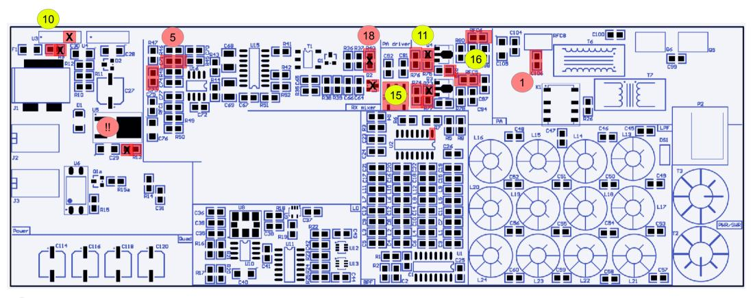
!! bei MØNKA-Bausatz U5 durch LF33ABDT-TR ersetzen
